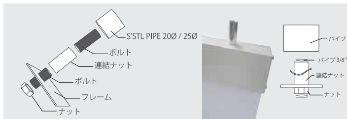
ボルト吊り下げ 1
